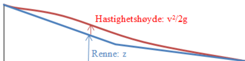
Figur 8: Energibetraktning (basert på (Brateng 2005 Figur 3.4)).
