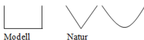
Figur 64: Illustrasjon av tverrsnitt på rennen i modellen og naturen.
