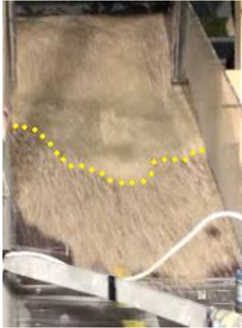
Figur 29: Vegg av masse og skredfront med grovkornet suspensjon, skred S1(-) (foto: Christiansen).
