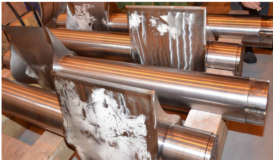
Figur 1.1: Skader på turbin på grunn av sedimenttransport.
