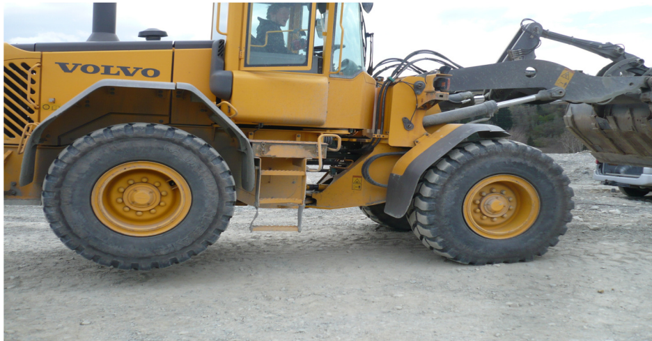
Figur 6.15 Løfting av hjullasterens bakhjul ved forsøk, H/D = 3.0
