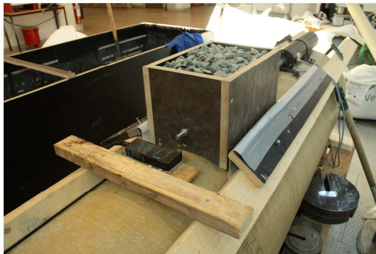
Figur 5.2 Oppsett av kasse for friksjonsforsøk
