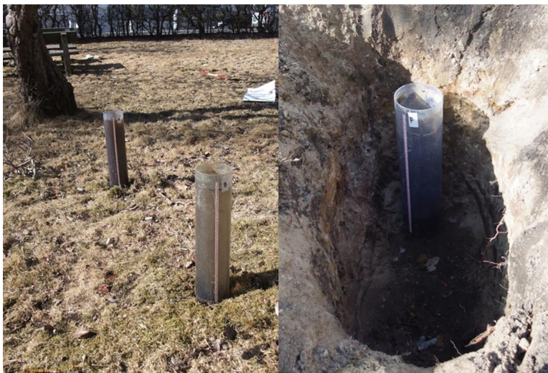
Figur 32 Infiltrasjonsmålinger på overflaten og 70 cm ned i jorden
