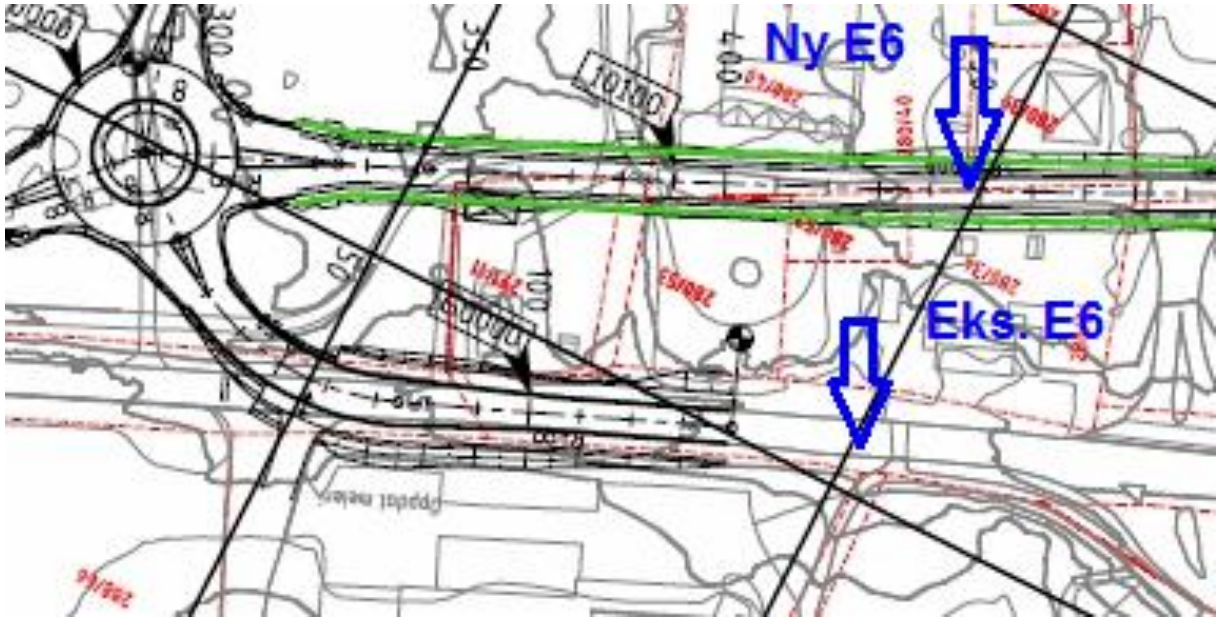
Figur 77: Tilknytning til eksisterende E6, illustrert på et utsnitt fra plandelen på D-tegningene.
