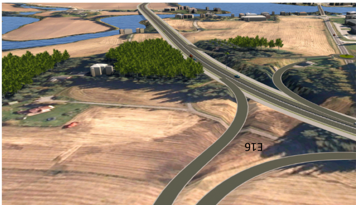
Figur 38 - Nordlige ramper kløverbladkryss
