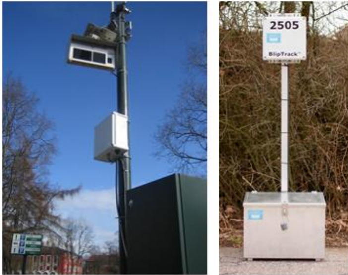
Figur 5 BlipTracks sensorer, fastmontert til venstre og mobil variant til høyre
