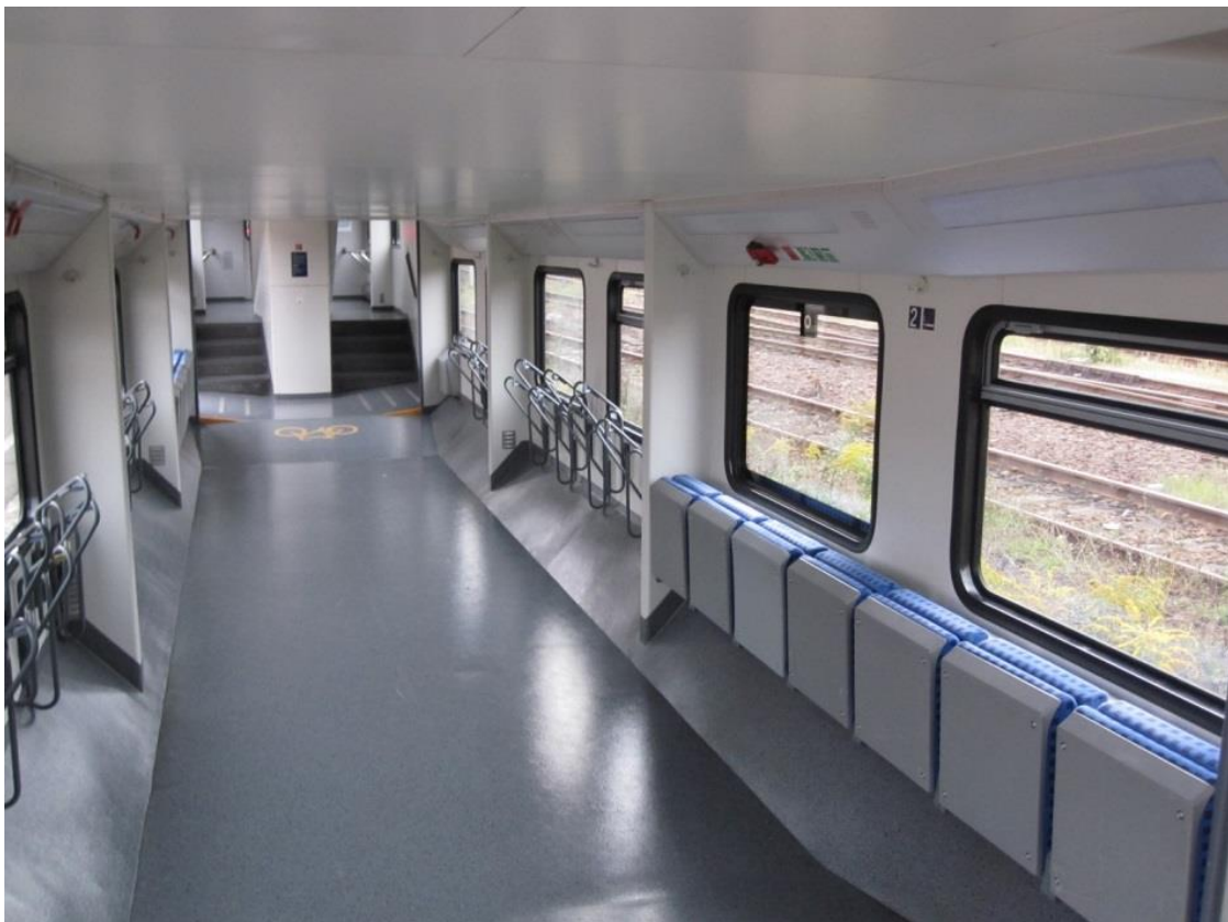
FIGUR 42: SYKKELAVDELING I EN TOETASJES VOGN (DBUZA 748 FAHRRADEXPRESS) HENTET FRA WIKIPEDIA COMMONS, BRUKER VIDEO2005
