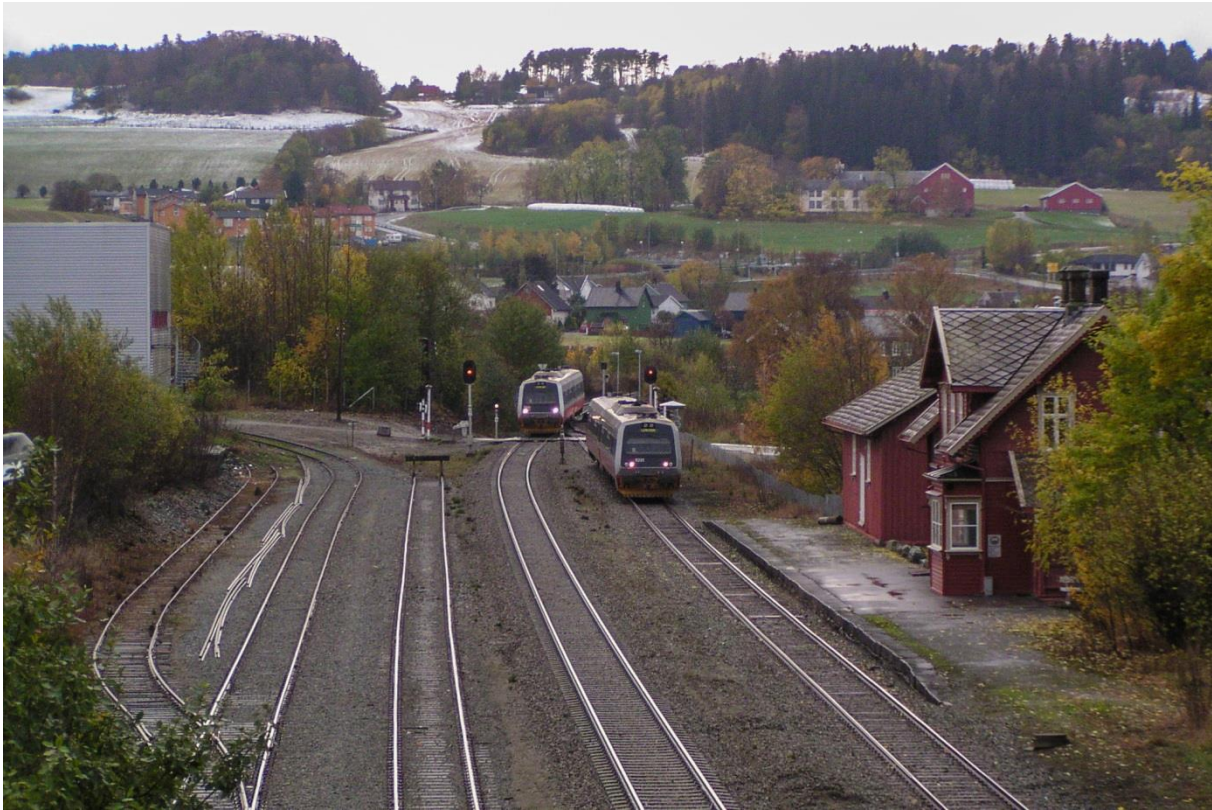
FIGUR 25: STÅENDE KRYSSING, HER VIST VED TO TYP 92-TOGSETT PÅ RANHEIM. FOTO: ØYVIND BERG, 2006
