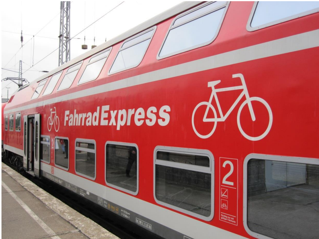
FIGUR 41: VOGN MED KAPASITET TIL 36 MEDBRAKTE SYKLER, DBUZA 748 FAHRRADEXPRESS. FOTO: WIKIPEDIA COMMONS, BRUKER VIDEO2005
