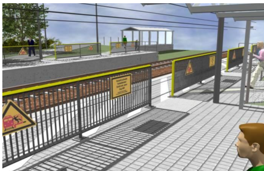
Figur 24: Stasjonsutforming med sikkerhetsgjerder (DB ProsjektBau, 2006)
