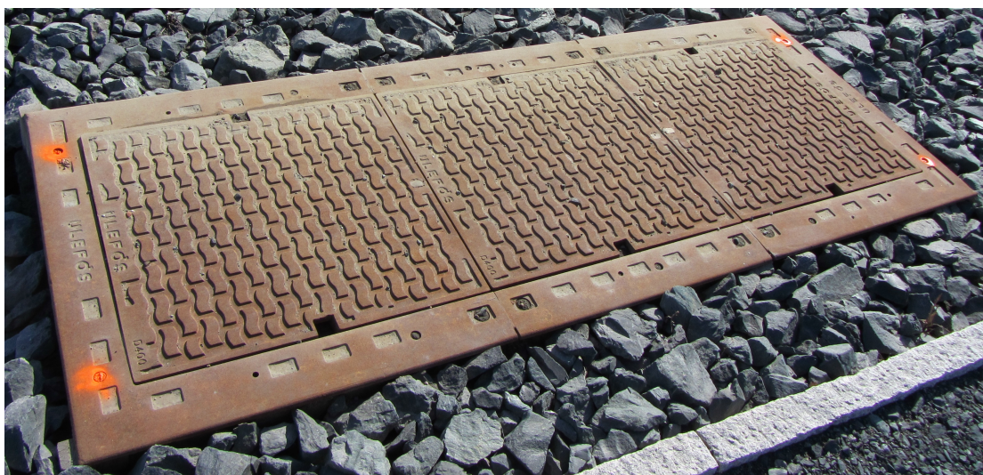
FIGUR 3.5: Innmåling av rektangulær kum med GNSS
