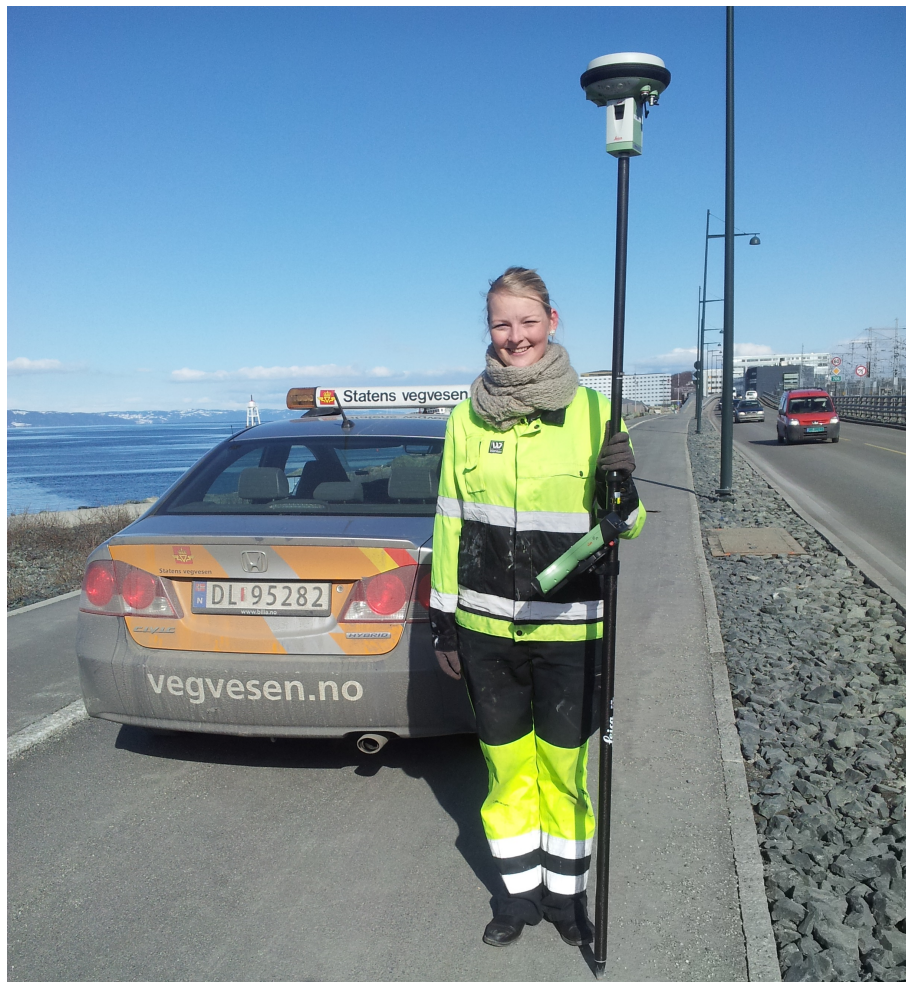
FIGUR 3.4: Innmåling av kontrollpunkter med GNSS
