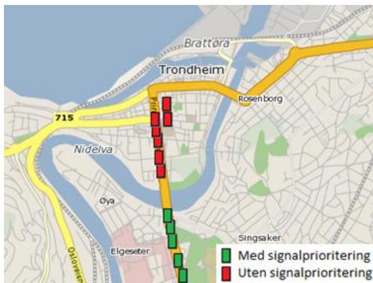
Figur 75: Med signalprioritering utvidet til Midtbyen og svært høy prioritet av stamrutene inn mot sentrum i morgenrush kan man spare opp til 3 minutter per tur
