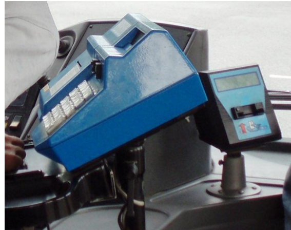
Bilde 5: Elektronisk billettering brukt flere steder på 90-tallet. Krever at kunden fører kortet gjennom en kortleser.
