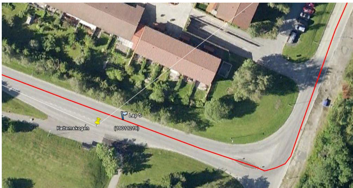
Bilde 35: Holdeplassen Kattemskogen ligger bare 70 meter fra et 90 graders kryss hvor bussen må ned under 20 km/t for å passere behagelig. Ekstra tidsbruk for å akselerere bussen fra stopp på holdeplassen blir derfor lavere enn et stopp på rettstrekk. Bildet er fra Google Earth med 0-kjøringen og holdeplassinformasjon lagt på
