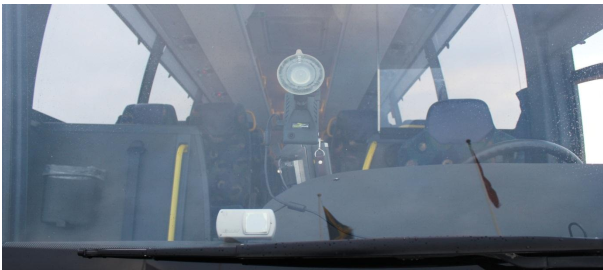
Bilde 29: Opptakene i bussen er gjennomført med videokamera festet på frontruten. Kameraet har innebygget GPS
