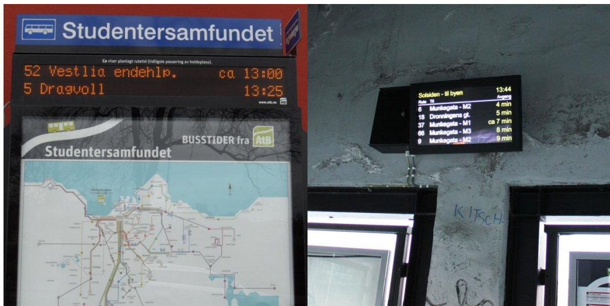
Bilde 26: På holdeplasser med få bussruter benyttes to linjers LED-skjermer. Til venstre vist ved Studentersamfundet. Til høyre er LCD-skjerm vist med plass til de neste fem bussankomstene. Fra Solsiden
