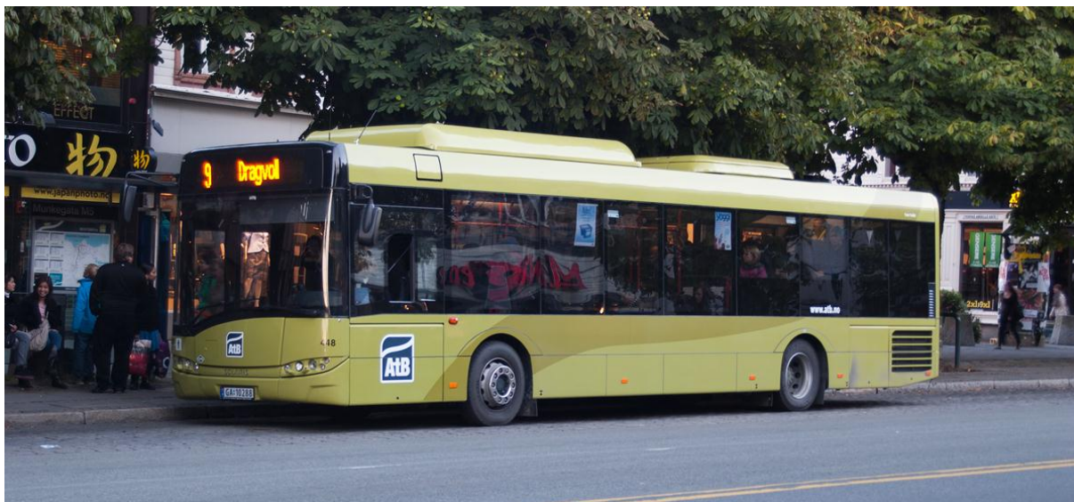
Bilde 28: Bussen som er brukt på registreringene. 12 meter Solaris med gassdrift. Bilde: Wikipedia
