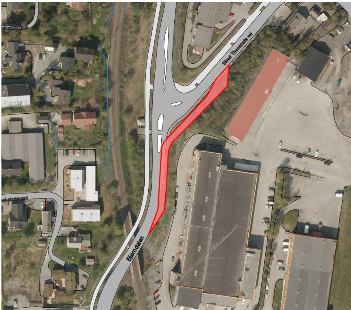
Figur 76: Det er bare et kjørefelt inn mot lyskrysset Bjørndalen - Sivert Thonstads vei. Her bør bussen få eget filterfelt eller høyresvingefelt
