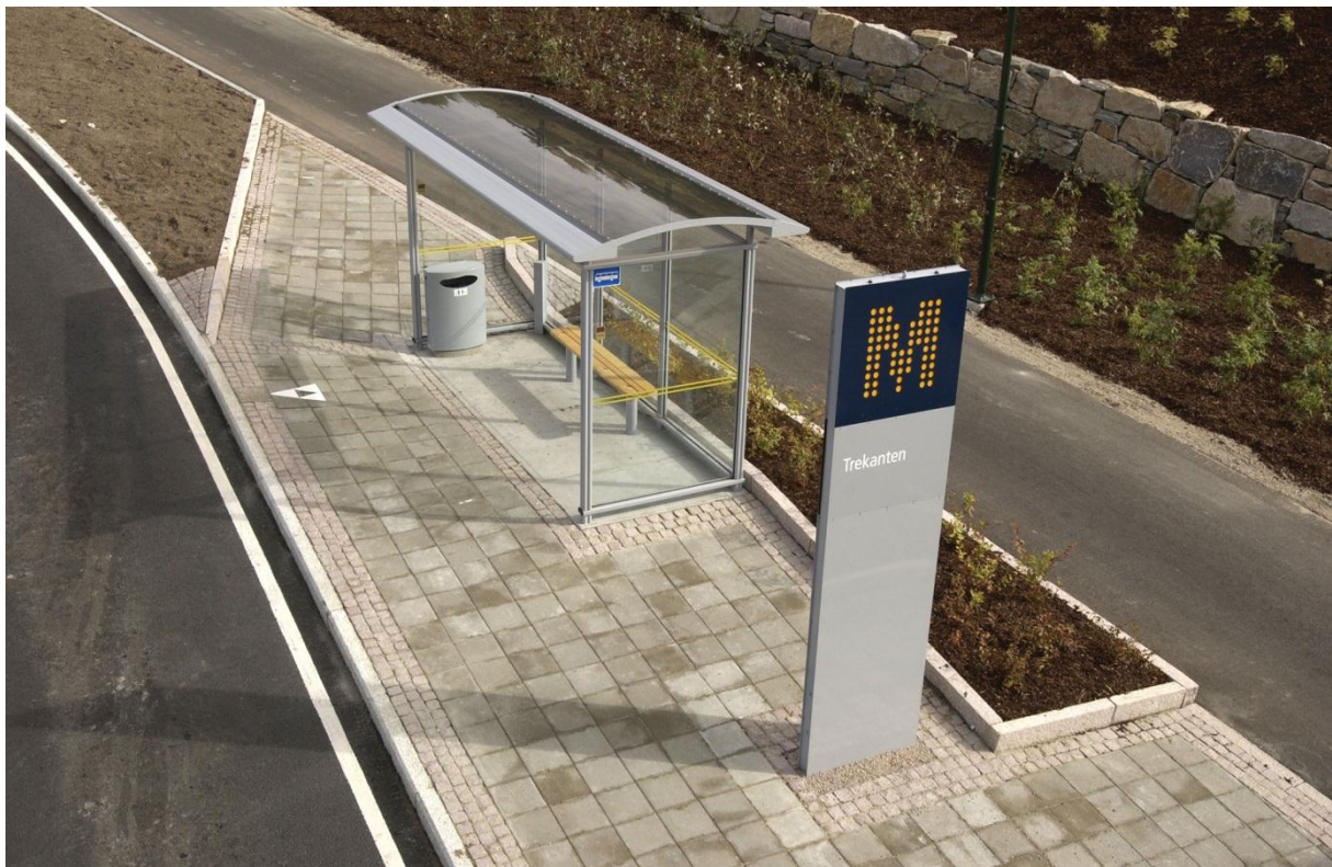
Bilde 19: Busmetro i Kristiansand med informasjonssøyle for sanntidsinformasjon. Løsningen vant pris for godt design, men den tekniske løsningen viste seg ustabil og er etter 10 år fremdeles ikke i drift. Bilde: Norsk design
