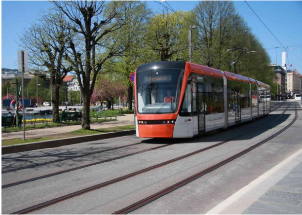
Bilde 1: Bybanen i Bergen åpnet i 2010. God prioritering og holdeplassavstand på 720 meter i snitt gir god reisehastighet. Bybanen vant Vakre Vegers Pris i 2012. Foto: Bybanen utbygging
