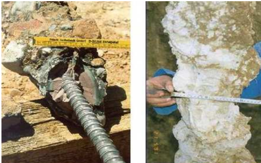
Figur 22 Bildene illustrerer hvordan trykkinjeksjon forbedrer friksjonsforbindelsen mellom sementsuspensjon og jordmasser (Con-TechSystems 2011).
