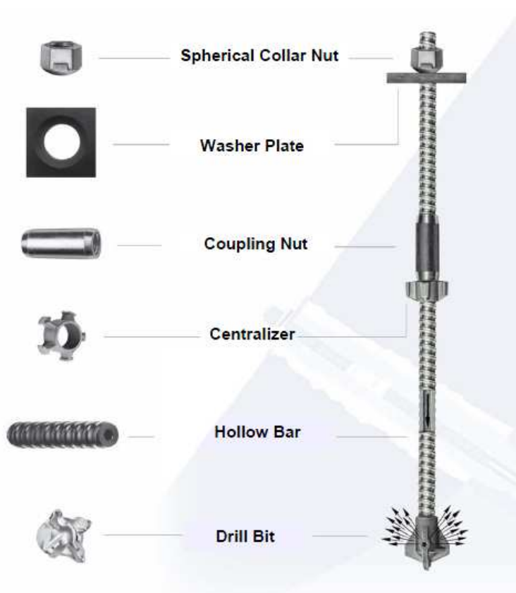
Figur 4 Ulike komponenter som inngår i en injeksjonspeler (TITAN 2010).
