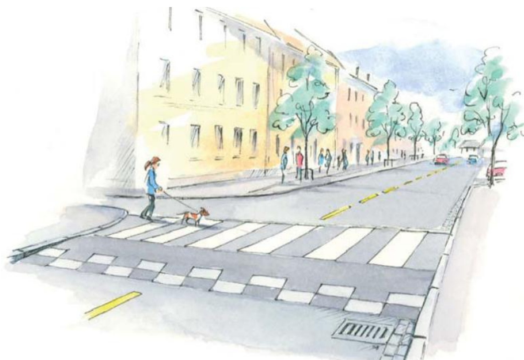
Figur 17: Illustrasjon av utførelse av trapeshump i by (Statens vegvesen 2006)
