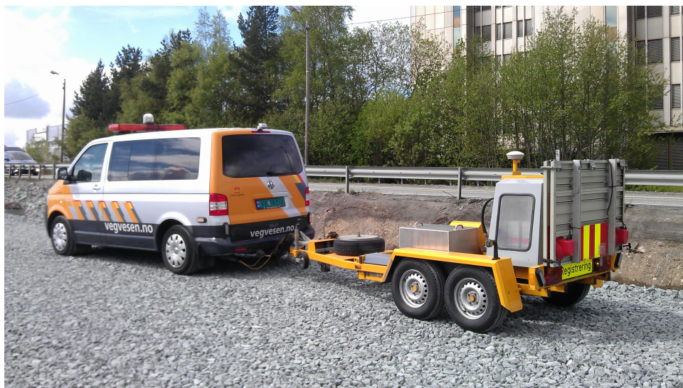
Figur 4.4 – Feltforsøk med fallodd 30.05.12 (Foto: M. Fladvad)
