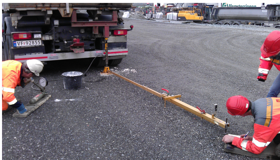
Figur 4.1 – Feltforsøk med platebelastning 16.05.12 (Foto: M. Fladvad)
