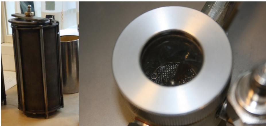
Figur 6 (t.v.) Ekstraksjonskøye og ekstraksjonssylinder
