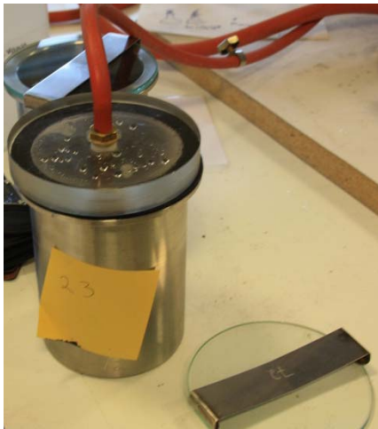
Figur 5 Pyknometer med undertrykk påført av en vannstrålepumpe
