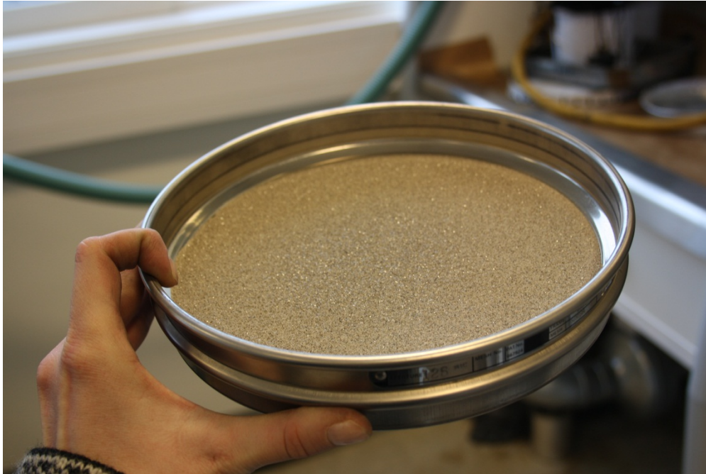
Figur 8 (t.h.) 0,125 - 0,250 mm-fraksjonen av det ekstraherte tilslaget
