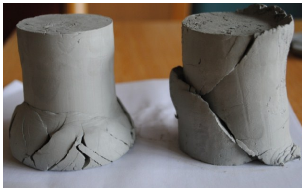
Figur 19 Typiske brudd etter enaksialforsøk. T.v. prøve fra 5 meter, t.h. prøve fra 6 meter.
