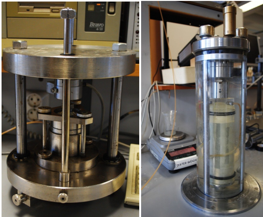
Figur 17 T.v.: Innebygd prøve i ødometerapparat. T. h: Innbygd prøve i treaksialapparat.
