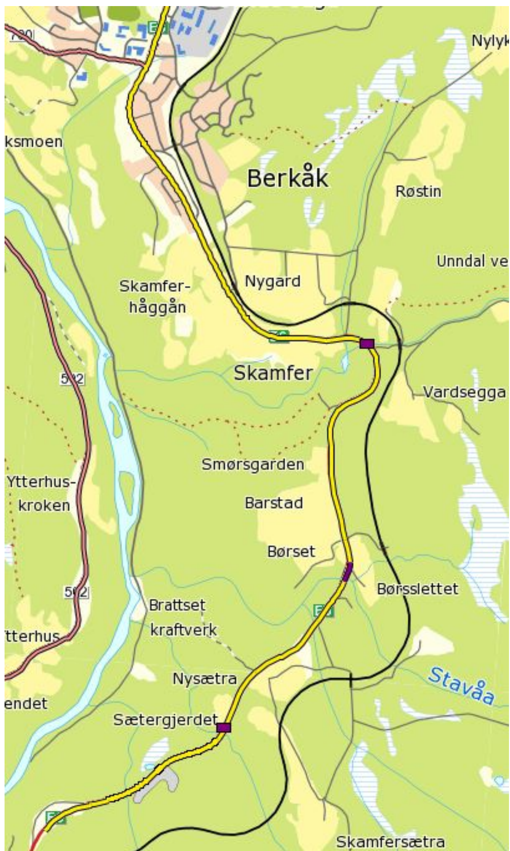
Figur 20: Eksisterende bruer i planområdet, merket med lilla strek [Statens vegvesen, 2012b]
