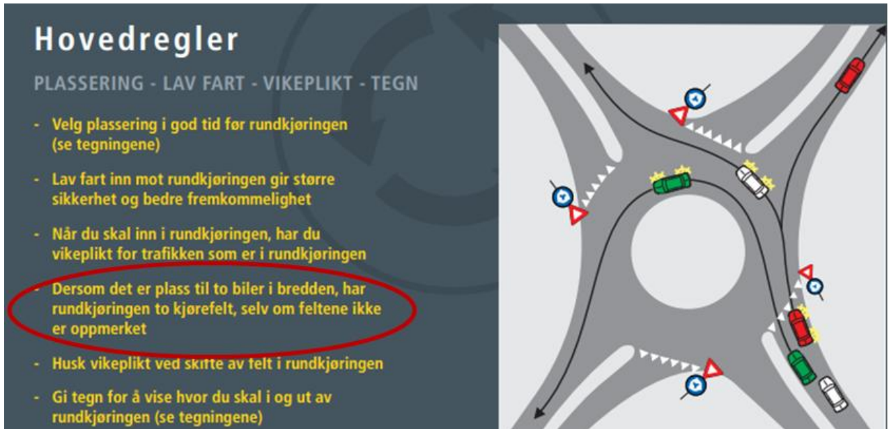
Figur 80 Ordinær posisjonering i rundkjøring (Statens Vegvesen, 2012).
