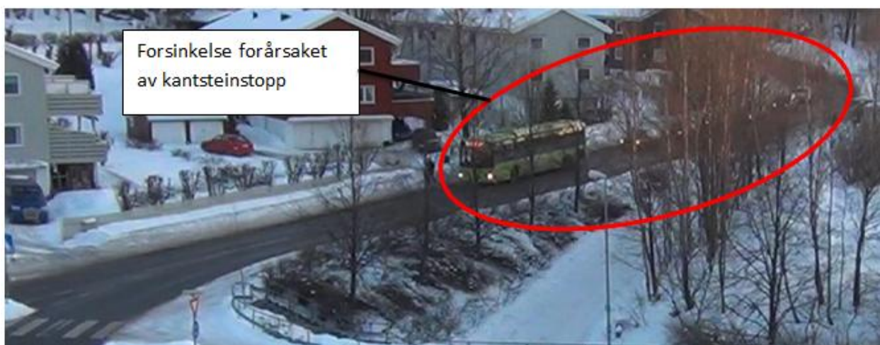
Figur 42 Forsinkelse i tilfart 2 forårsaket av kantsteinstopp.
