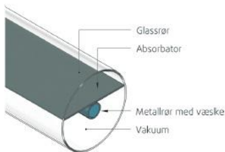
Figur 5 - Oppbygging av en vakuumsolfanger (Byggforsk, 2011b)
