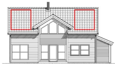
Figur 24 - Plassering av solcellepaneler på taket til Sans
