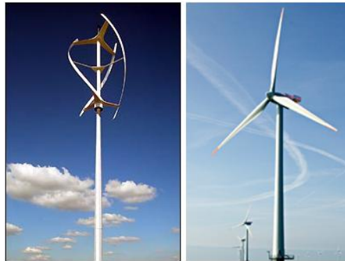
Figur 6 - V: Vertikalakslet turbin (energitilskudd.no, 2012). H: Horizontalakslet turbin (NGI)
