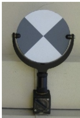
Figur 14: Target for laserskanning av bygninger (HTS)
