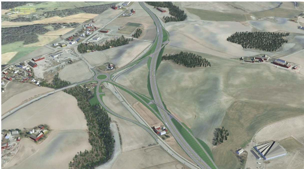
Figur 27 Oversiktsskisse. Foreslått utforming av Klett-krysset.
