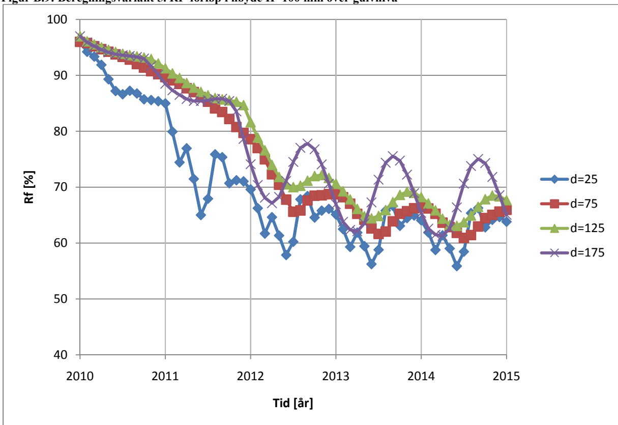
Figur B.10: Beregningsvariant 5. RF-forløp i høyde H=1000 mm over gulvnivå
