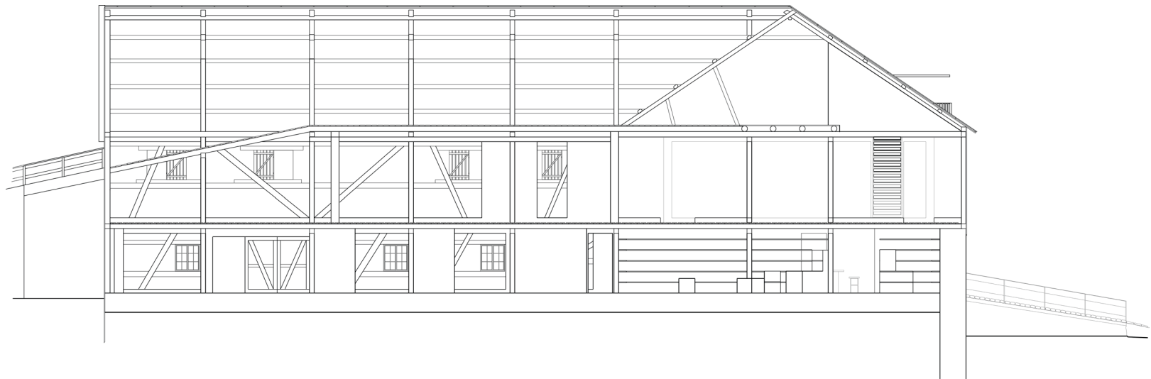
Tverrsnitt mot nord som viser organisering for ny bruk av den gamle driftsbygningen, 1:200.
