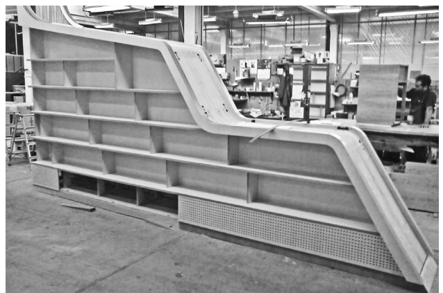
26/7-2011. Prøve monteringen av de prefabrikerte hyllemodulene.
