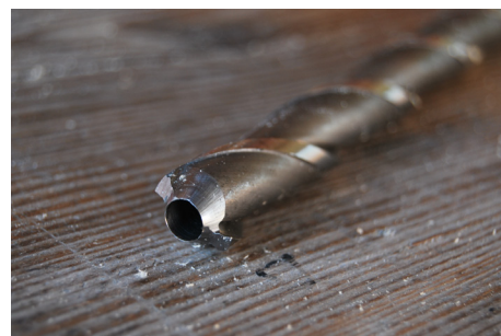
Det hole boret som blir brukt ved taking av dendroprøver lagar eit 16 mm stort hol.
