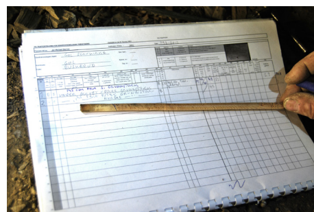
Dendrokronologisk boreprøve (Ø 7 mm) og skjema med informasjon om prøvetakinga for innsending til analyse.
