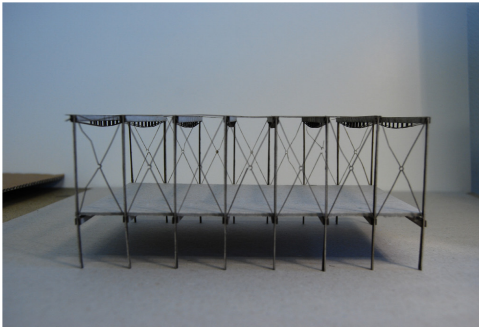
Tre i Kombinasjon med stålvaiere gir etn lett og slank konstruksjon
