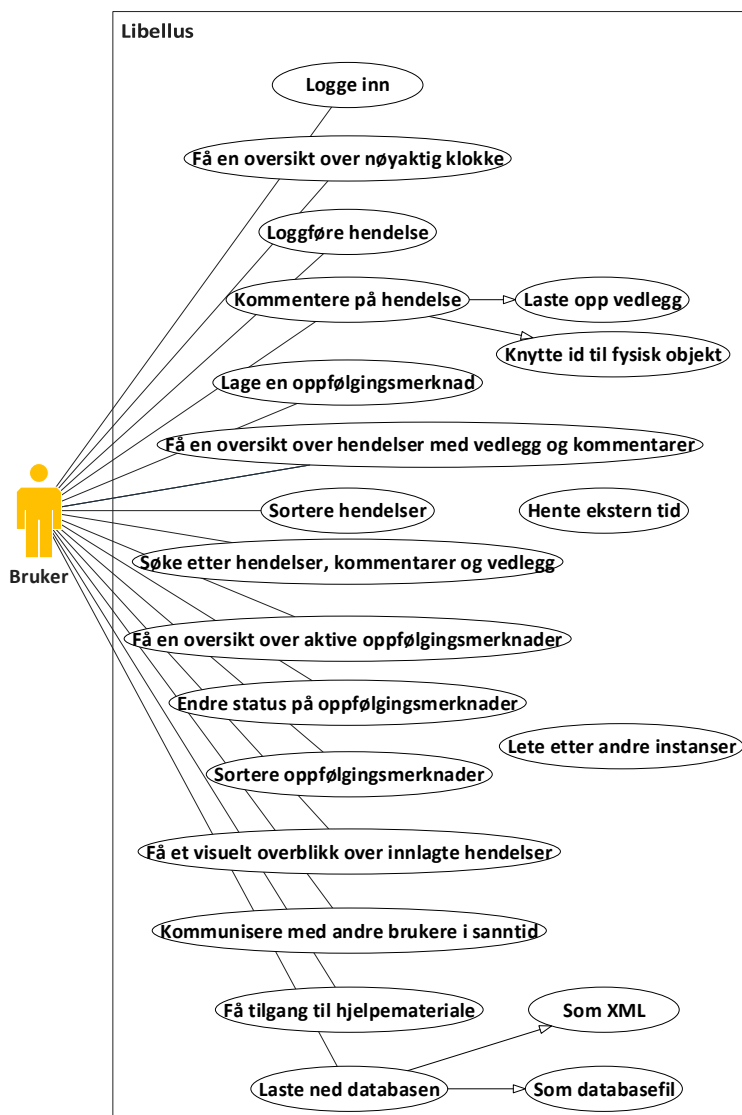
Figur 3: Bruksmønsterdiagram - Brukeren i systemet er loggføreren
