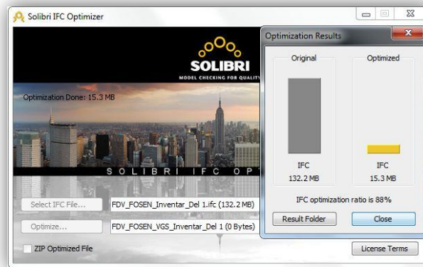
Figur 43. Reduksjon av IFC-fil fra inventar del 1. Behandlet fil er 8,8 ganger mindre!
