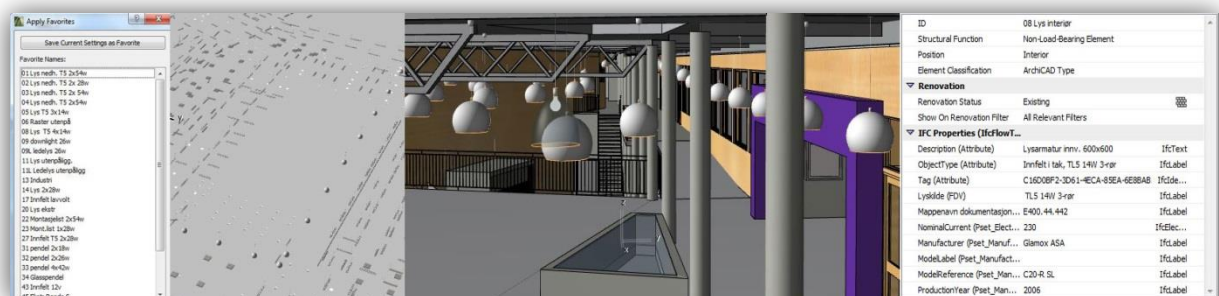
Figur 31. Bilde til høyre viser interiør pendel-lysarmaturer og eksempel på IFC-egenskaper for en innfelt armatur i systemhimling. Til venstre noen av armaturene lagret med IFC-innstillinger som favoritter i ArchiCAD.
