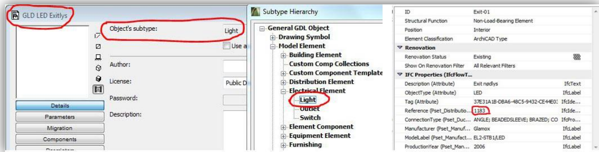
Figur 30. Custom objekt av markeringslys/ exitlys. IFC-egenskaper som bl.a. viser referansenummer til høyre.
