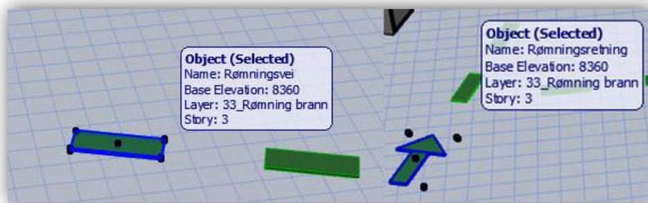
Figur 27. 3D-objekter som viser rømningsvei og rømningsretning.
