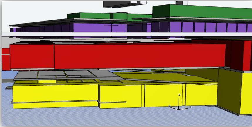
Figur 12. Feil høyder på romobjekter i opprinnelig modell. Lagvisning med systemhimling, dekker og romobjekter med farge.
