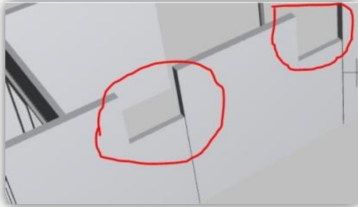
Figur 10. Felt over gjenmurte, gamle døråpninger var ikke modellert.
