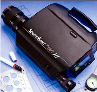
Fig. 4.4.1 Photo Research PR650 SpectraScan spektroradiometer. Innkjøpspris inkl. moms ca. 210.000 NOK. Arbeidsgruppen foreslår at det utvikles en metode for kalibrering og profilering av videokanoner basert på digitalkamera.
