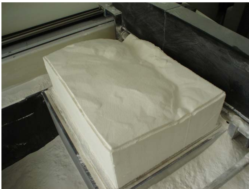
Figur 13. Kartmodell i 3D printer med understøttelse/ fixture
