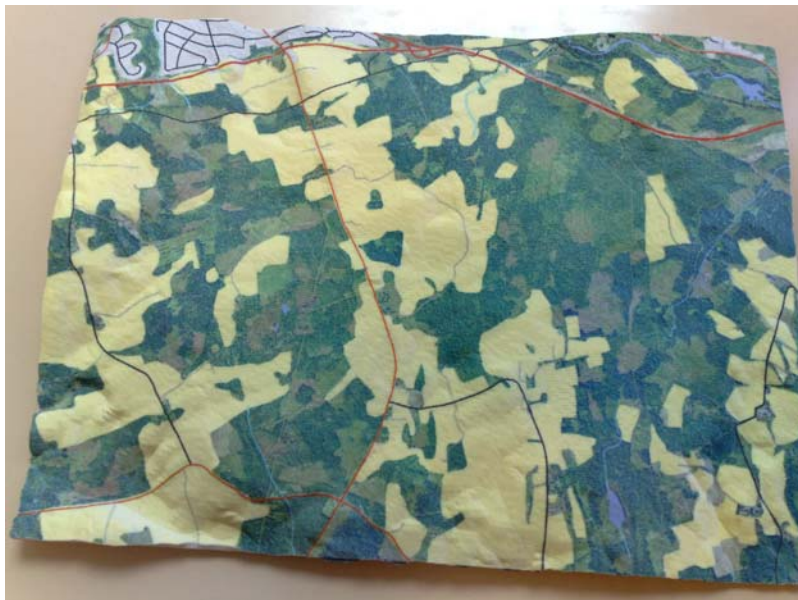
Figur 17. Kartplate i gips produsert i farge-3D-printer(2009)
