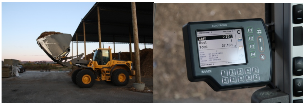
Bilde 1 og 2. Hver skuff tar ca.11 lm 3 og veier i dette tilfelle 2.75 tonn(Solør Bioenergi CHP)
