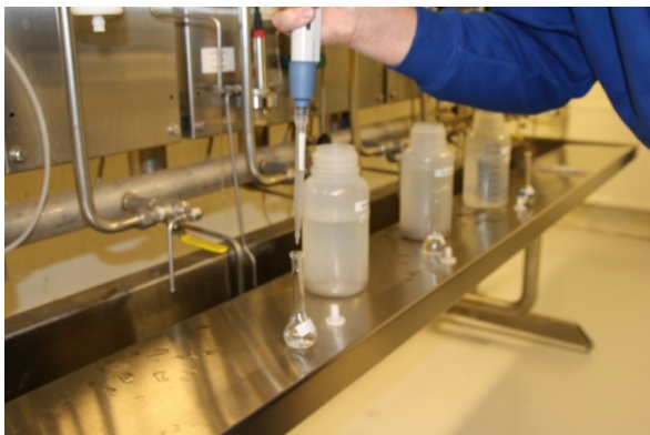
Bilde 30. Laboratoriebenk for prøvetaking av vann i forskjellige stadier i kjelen.
