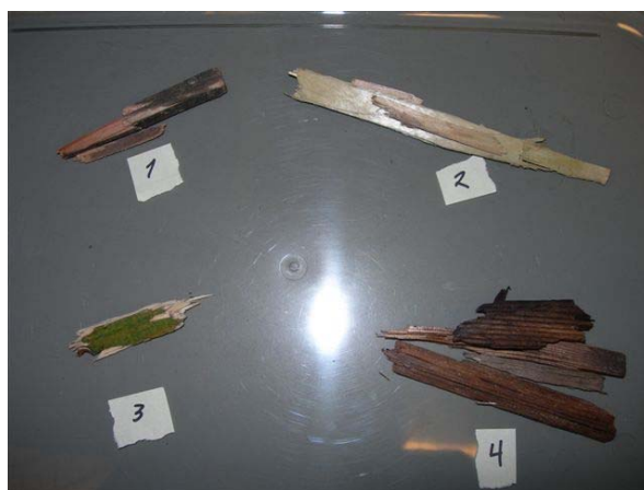
Prøvene til kalorimeteret. 1 og 3 er returtre med sopp og maling, Nr 2 er CCA-impregnert, mens nr 4 er kreosotflis.
