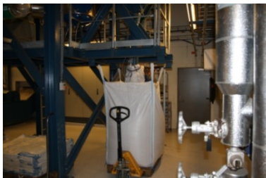
Bilde 13. Big bag for sveveaske sammen med kalk og kull (600 kg avfall pr sekk)
