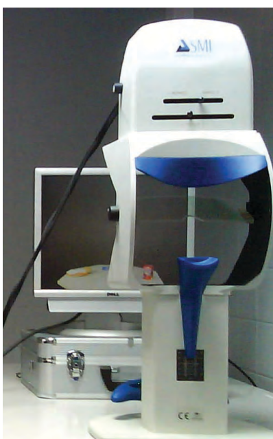
Figur 2: iViewX Hi-Speed eyetracker, hakestøtte og pannestøtte i blått
