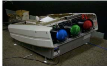
Figur 4: CRT-projektorer har tre katodstrålerør. [8]
