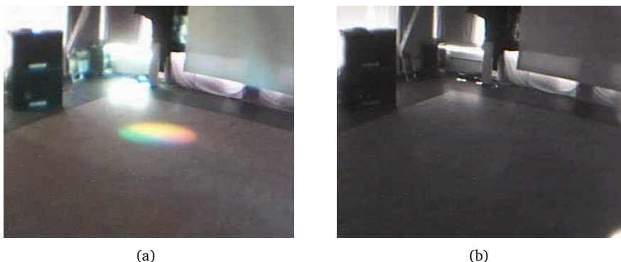
Figur 26: Bilde a er fra videoopptaket uten IR-filer og bilde b er fra opptaket med IR-filer. Pæren i scanneren hadde en fargetemperatur på 6000 kelvin på begge opptakene.
