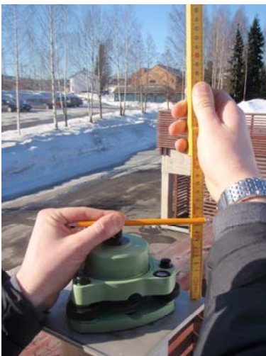
Figur 5 - Måling av bolthøyde, antennen har internt referansepunkt (Bilde: Jeanette Beinset Magnus)
