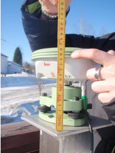
Figur 4 - Måling av antennehøyde, referansepunkt er midtre gummiring (Bilde: Jeanette Beinset Magnus)
