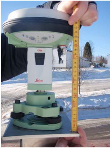
Figur 6 - Måling av antennehøyde, referansepunkt er midtre gummiring (Bilde: Jeanette Beinset Magnus)
