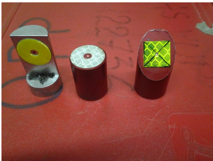
Figur 8: Magnetprismer med ulike former etter hvilken synsvinkel man har fra totalstasjon.
