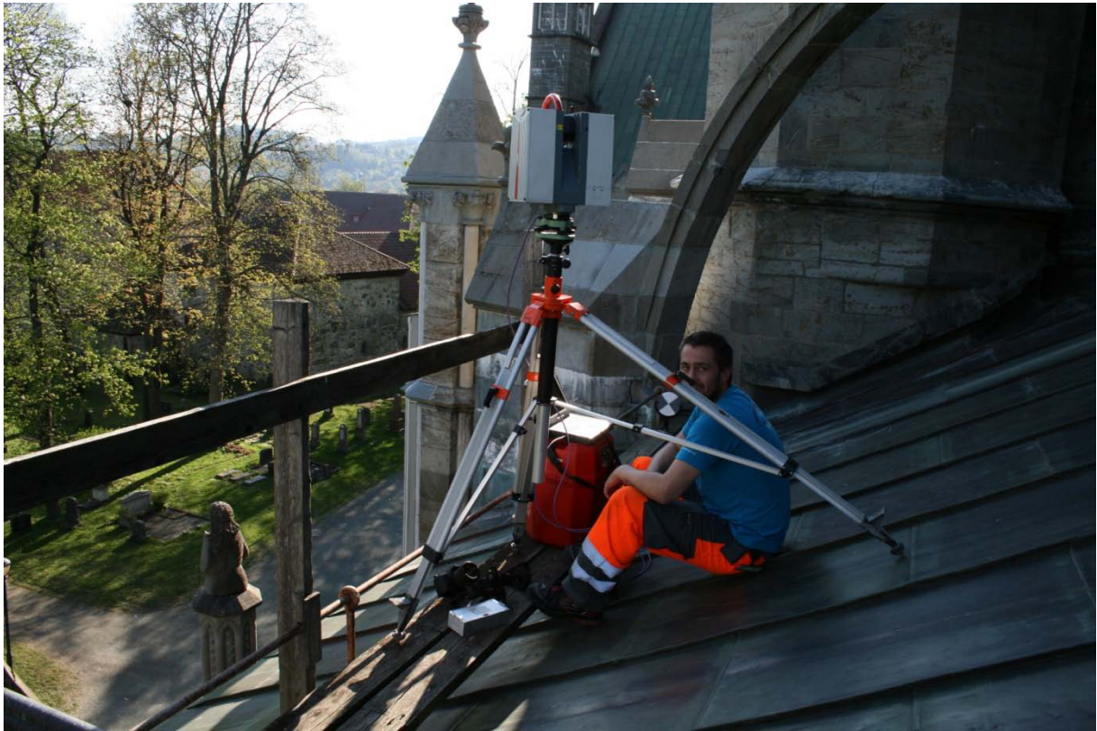
Figur 6: Leica HDS6100 på taket av Nidarosdomen
