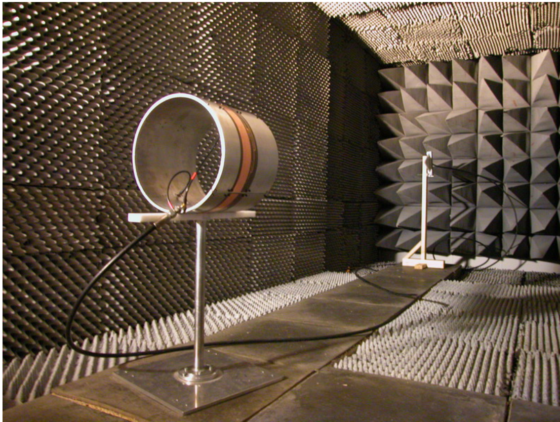
Figur 20: Måleoppstilling inne i FFI's refleksjonsfrie rom.
