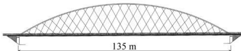
Figur 1: Prinsippskisse av nettverksbru (Tveit 2011)
