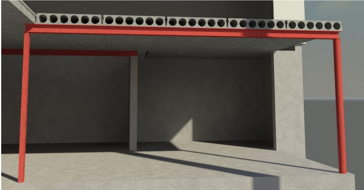
Rendering 9 Søyler under bjelke ved spiserom. HUP til venstre og rund søyle til høyre
