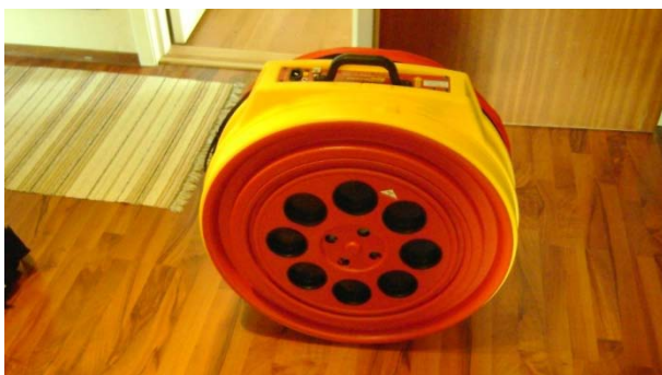
Figur 22 – Trykktestings vifte – Blower door Foto: Stian Mathisen
