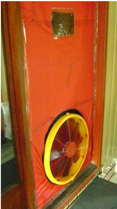
Figur 28 – Trykktestingsutstyr montert og tettet godt med teip. Foto: Bjørn Christian Bøe
