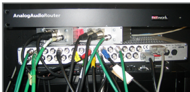
Audiomatrisen fra Network Electronics – her i bruk i applikasjonene vi var med å bygge i Stockholm. Under kan man se deler av de fiberoberoptiske tilkoblingene.
