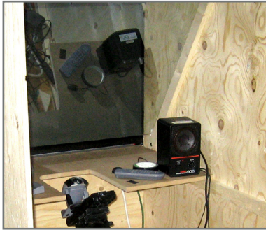
Prinsippet med display bak speilet, og kameraet henter motivet via speilet.
