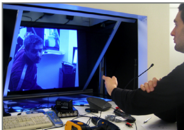
Prinsippet med liggende display og kameraet bak speilet
