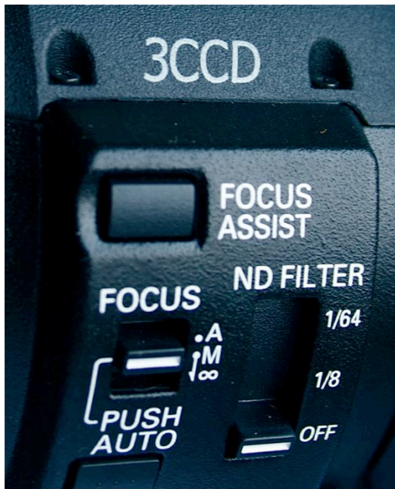
Fig 02 ND-filteret på HVX200.
