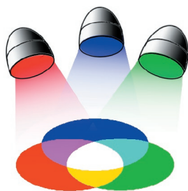
Figur 3.4: Ved å legge til, addere, grunnfargene rød, grønn og blå oppfattes det hvitt lys.
