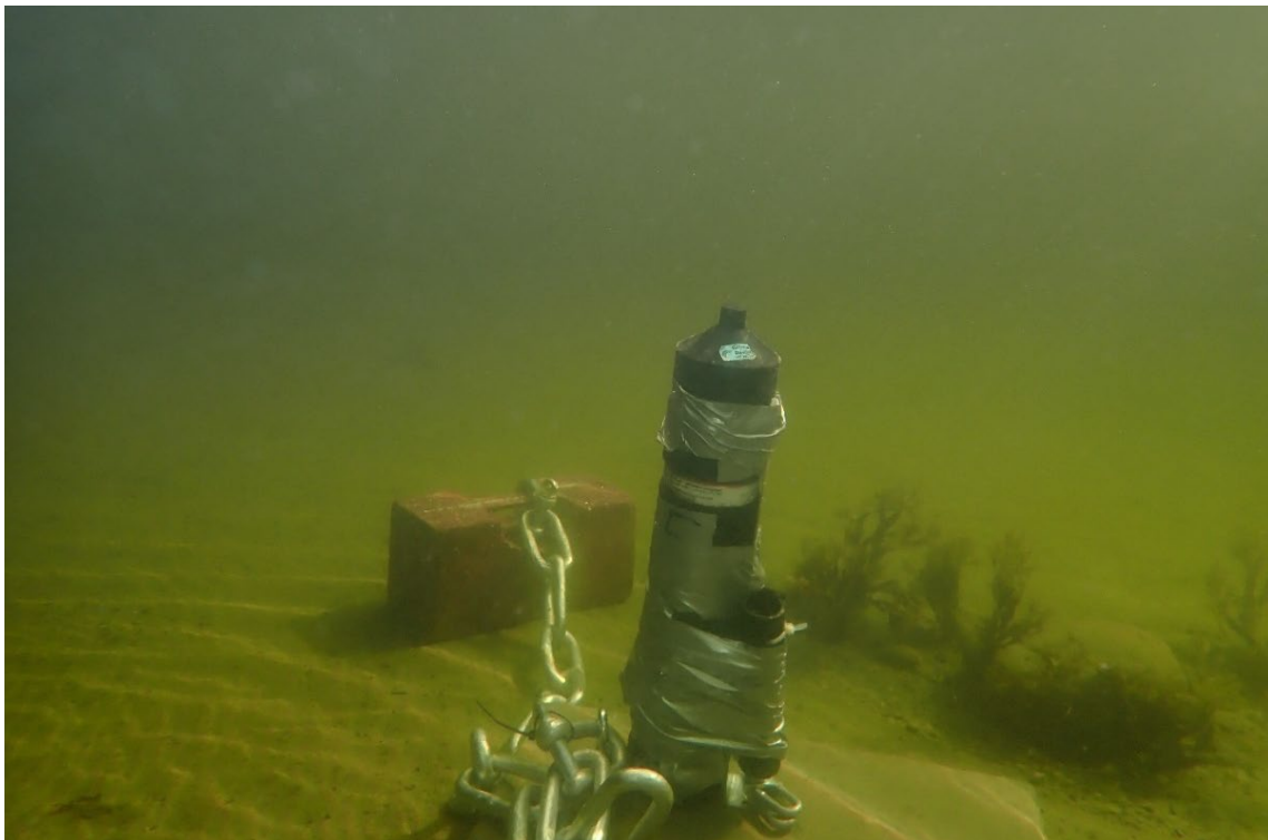
Lyttestasjon og datalogger for temperatur og salinitet (liten svart sylinder) plassert på bløtbunnsområdet ved Ørin. Foto: Jan Grimsrud Davidsen.
