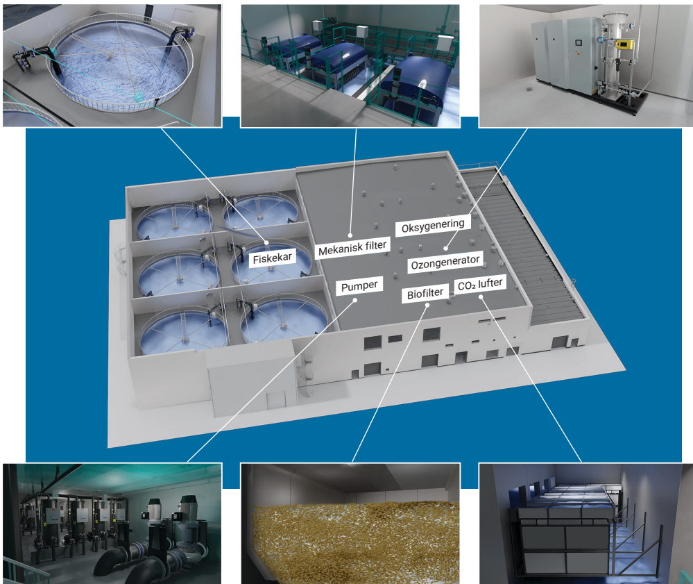
Figur 22.8. Et moderne RAS med lokalisering av kar, biofilter og renseutstyr (med tillatelse fra Sterner AS).
