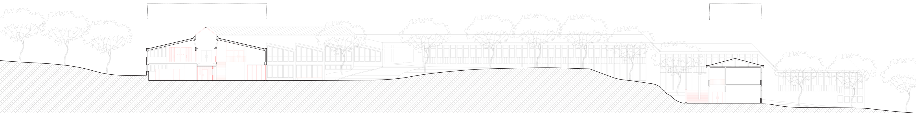
1: 400 SNITT B-B som viser den nye mathallen med tilknyttede uteområder og den nye arkaden langs voksenopplæringsbygget nedover på tomta
