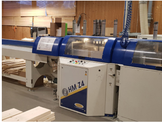
Treverk blir kuttet og frest.
