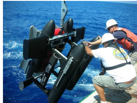
(d) The In situ Ichthyoplankton Imaging System (ISIIS).
