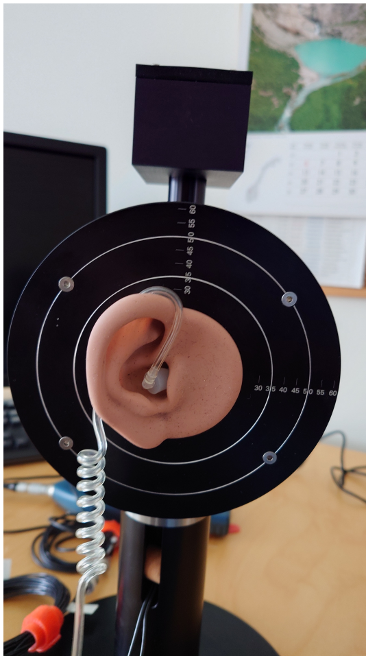
Figur 3.9: Oppsett ved måling på generisk ørepropp
