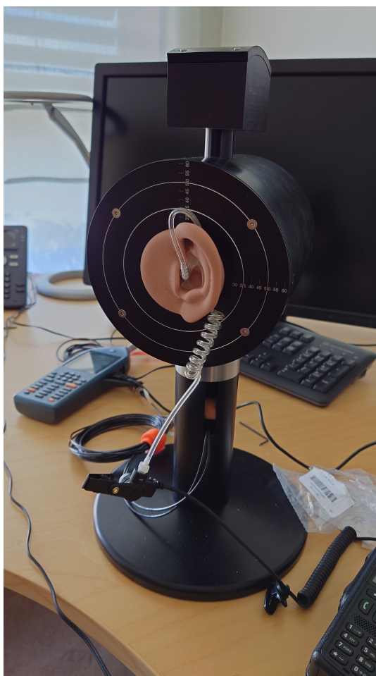
Figur 3.10: Oppsett ved måling på anatomisk ørepropp.
